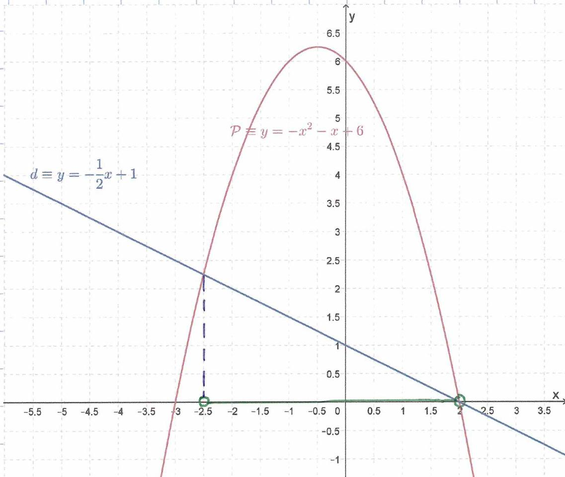
La parabole est au-dessus de la droite si  $x \in ]-\frac{5}{2}, 2[$ . Elle la touche en  $x = -\frac{5}{2}$  et  $x = 2$ .
